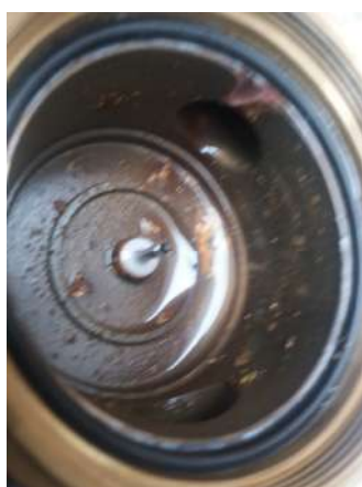
CANASTILLA DEL MEDIDOR CON SARRO
