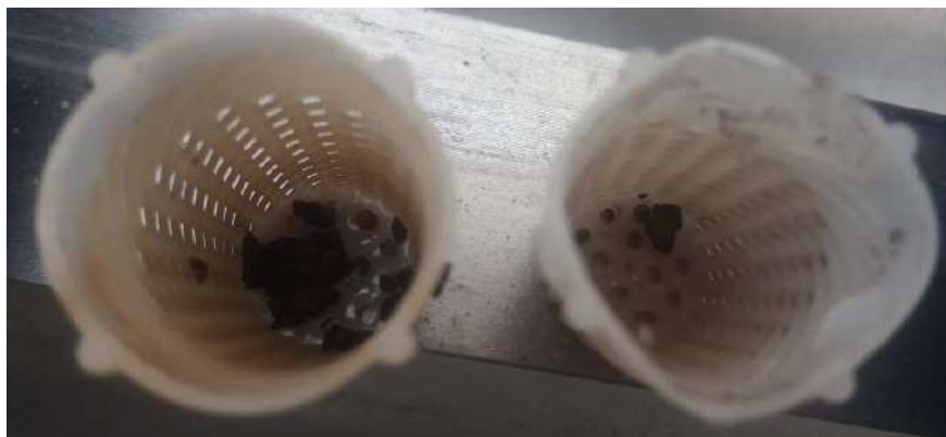
CANASTILLA DEL MEDIDOR CON SARRO
