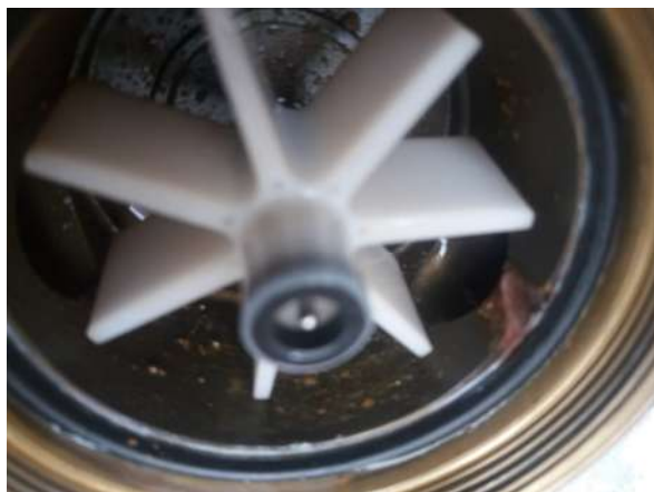
CANASTILLA DEL MEDIDOR CON SARRO
