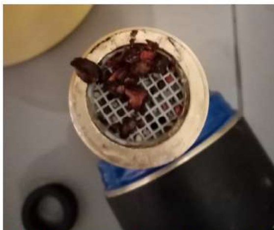
IMPUREZAS ENCONTRADAS EN EL FILTRO DEL MEDIDOR
